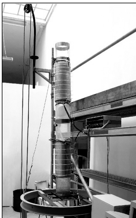
Rys. 1. Stanowisko badawcze: widok silosu ze ścianami gładkimi i elektrodami pomiarowymi Fig. 1. Silo structure used in the tests: view of silo with smooth walls and measurement sensors
