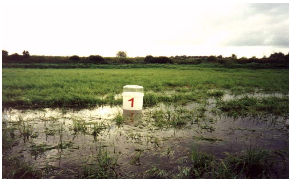
Rys. 23. Pole nawadniane ściekami miejskimi po II stopniu oczyszczenia, widoczny klosz do oznaczeń emisji gazów z gleby pokrytej mieszką traw
