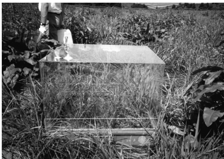
Rys. 24. Komory do gromadzenia wydzielanych gazów
