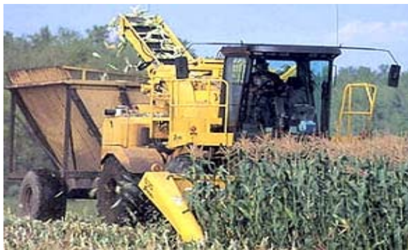
Rys. 11. Widok samojezdnego kombajnu EL 30 HARVESTER podczas pracy [94]
