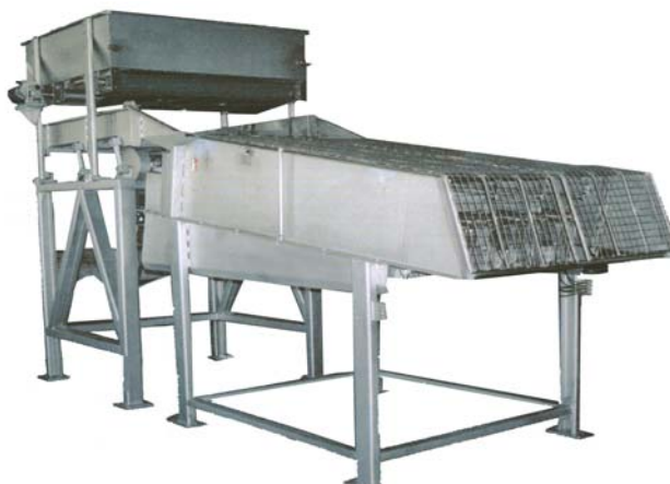
Rys. 14. Obrywarka liści okrywowych kolb kukurydzy OLK-8 [94]
