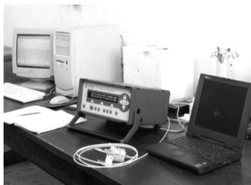
Fot. 2. Stanowisko pomiarowe z analizatorem gazów typu Multi Gas Monitor model 1312 i sondą pobierania powietrza Photo. 2. Measurement set stand with gas analyzer Multi Gas Monitor type 1312 and air sampling probe
