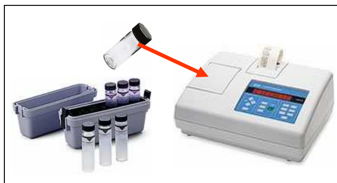
Rys. 1. Turbidimetr HACH 2100 AN do określania zawartości w glebie łatwo-dyspergującego iltu (RDC)
