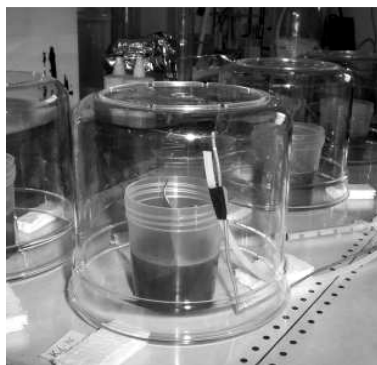
Fot. 1. Komora małejobjętościowa z sondą powietrza i próbką materiałową Photo. 1. Small capacity measuring chamber with air sampling probe and material sample
