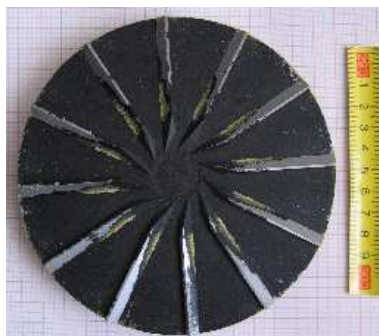
Fot. 2. Tarcza obłuskująca Photo 2. Hulling machine disk
