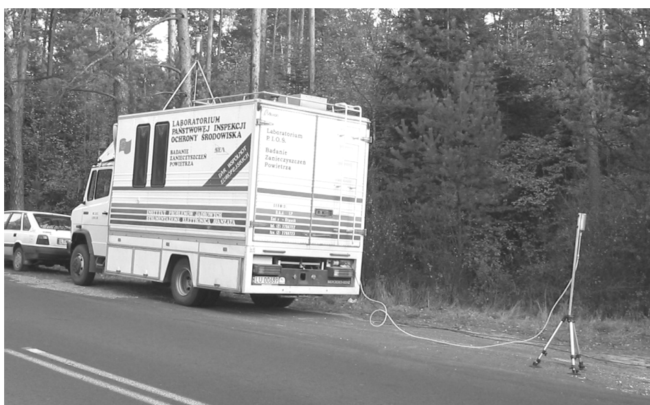
Rys. 89. Pomiar zanieczyszczenia powietrza laboratorium mobilnym Fig. 89. Air pollution measurement with a mobile laboratory
