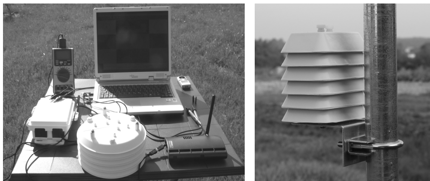
Fot. 1. Stanowisko polowe kontroli pracy układu pomiarowego złożonego z termometrów elektrycznych (po lewej) oraz czujnik rezystancyjny w osłonie radiacyjnej w czasie pomiaru (Durlo 2007)
