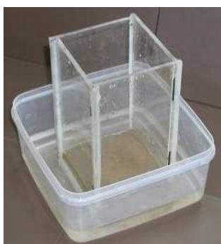
Rys. 1. Pojemnik z badaną glebą i naczynie zewnętrzne z wodą
