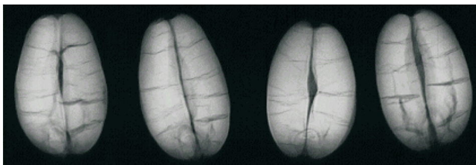
Rys. 4. Rentgenowskie obrazy ziaren pszenicy: a – bez widocznych uszkodzeń; b – z pęknięciami – po nawilżaniu i delikatnym suszeniu; c – z pęknięciami – po nawilżaniu i intensywnym suszeniu
